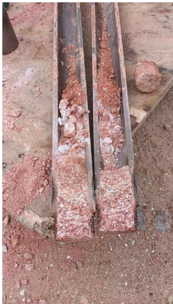
Foto 4 – Amostrador, solo padrão no final dos furos
