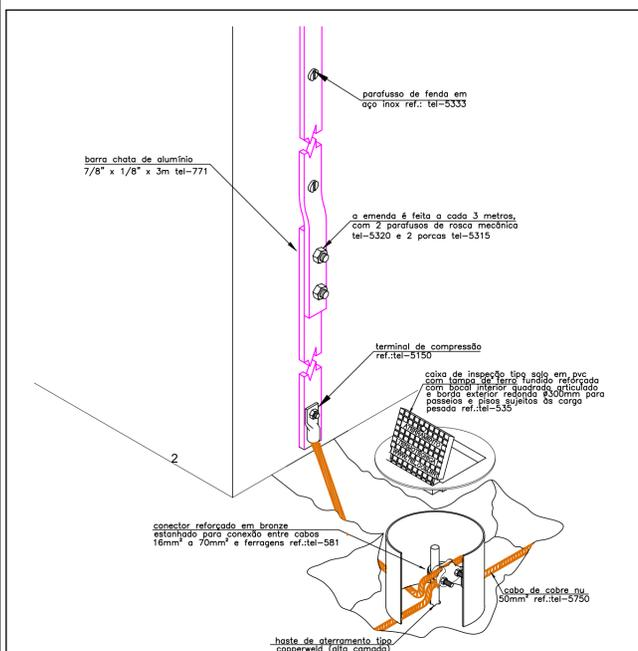
DETALHE 1 - DESCIDA EM BARRA CHATA DE ALUMÍNIO COM O ATERRAMENTO SEM ESCALA
