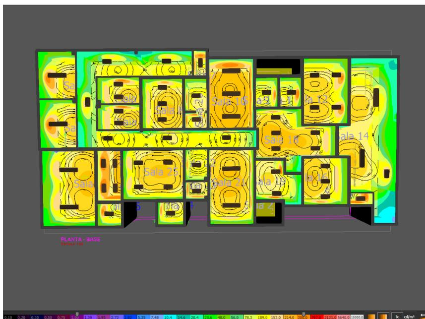
Figura 1 - Resultado da Simulação no Dialux.
